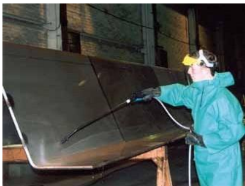
Passivace dílu, který bude součástí objemného chemického tankeru z oboustranné nerezové oceli
